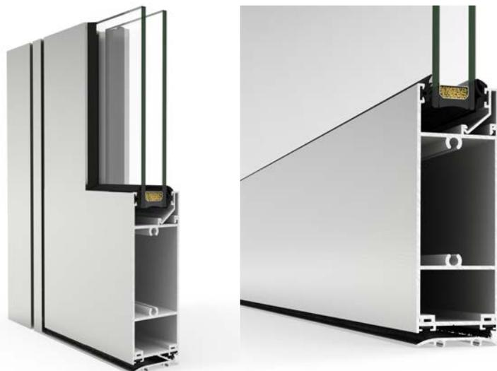
Sistema de puerta peatonal para locales comerciales y edificios que permite incorporar bisagras superpuestas de dos y tres palas de alta resistencia capaces de soportar hasta 180 Kg de peso por hoja.
