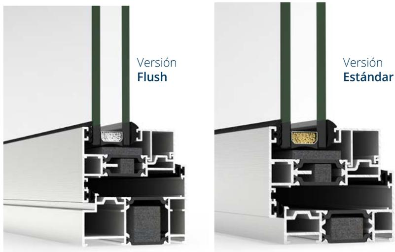
Ventana con rotura de puente térmico que posibilita la apertura exterior tanto practicable como proyectante a la inglesa. Esta solución, con rotura de puente térmico de 32 mm y un valor de transmitancia  $U_w$  desde  $1,0 \text{ W/m}^2\text{K}$ , cuenta con la certificación de seguridad británica PAS 24, siendo especialmente indicada para este mercado.
