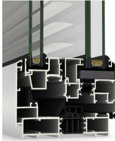
Sistema especialmente indicado para edificaciones ubicadas en zonas con elevada actividad acústica. Esta ventana con rotura de puente térmico y doble hoja oculta de 122 mm, con cuerdilla y 4 vidrios, permite alcanzar una atenuación del ruido de hasta 50 dB.
