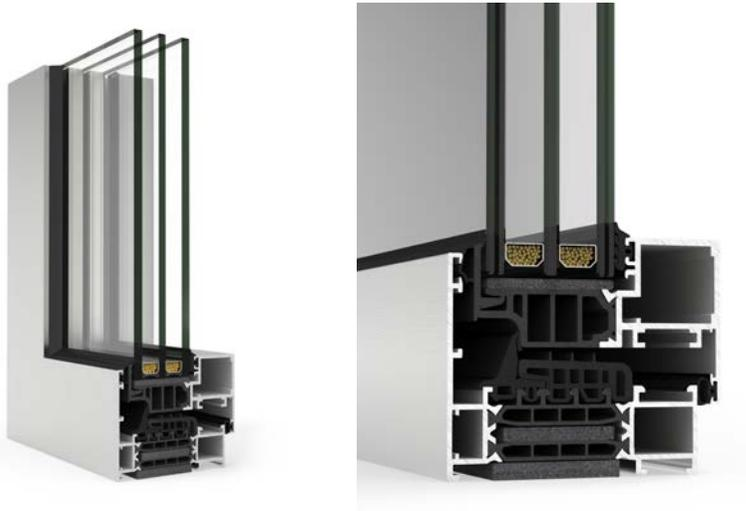
Elegante diseño de líneas rectas en el que se oculta la hoja tras el marco, maximizando así la superficie acristalada y la entrada de luz. Todo ello, acompañado de un gran rendimiento térmico y acústico impulsado por la rotura de puente térmico de 45 mm y una capacidad de acristalamiento de hasta 51 mm que permite la instalación de vidrios triples.
