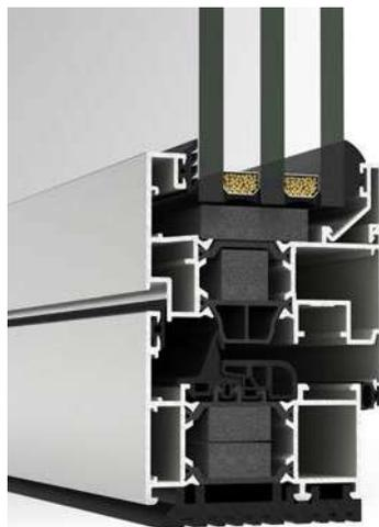
Sistema abisagrado de 70 mm de profundidad de marco compatible con cualquier herraje de canal 16 estándar. Presenta una rotura de puente térmico de 35 mm en marco y 30 mm en hoja, ofreciendo un gran rendimiento térmico y acústico.
