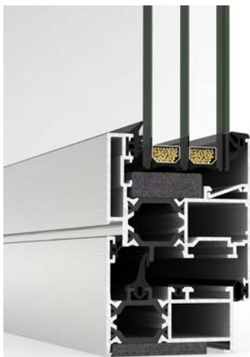
Sistema abisagrado de 54 mm de profundidad de marco con rotura de puente térmico de 24 mm y una capacidad máxima de acristalamiento de 41 mm; características que le confieren un óptimo rendimiento térmico,  $U_w$  desde  $1,0 \text{ W/m}^2\text{K}$ , y acústico, hasta 46 dB de protección frente al ruido.
