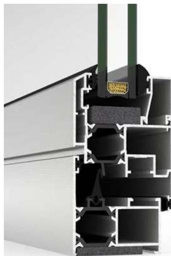
Compatible con cualquier herraje de canal 16 estándar del mercado, este sistema abisagrado de 54 mm de profundidad de marco y una rotura de puente térmico de 24 mm se presenta como una solución versátil para climas suaves.
