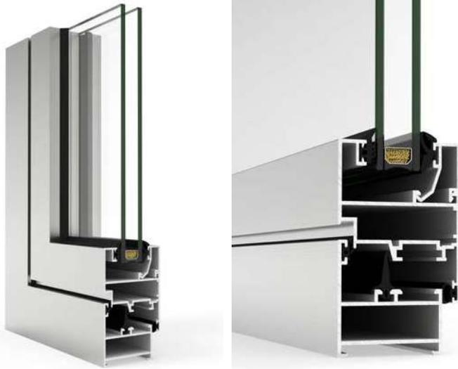
Sistema abisagrado de canal europeo con una capacidad de acristalamiento de 31 mm. Su espesor de perfilera, 1,5 mm en la versión de ventana y 1,7 mm en la de puerta, le confiere una excepcional rigidez y durabilidad.
