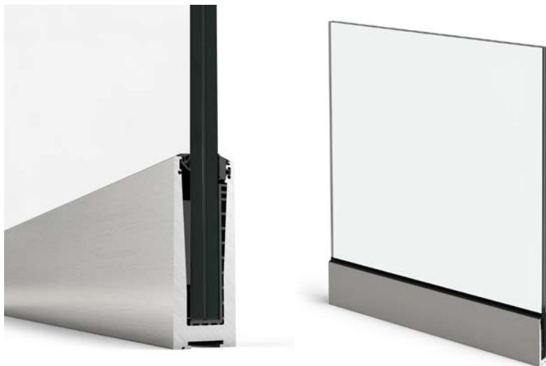
Disfruta de excelentes vistas sin ningún tipo de obstáculo, gracias a este sistema de barandilla basado en un perfil de aluminio con forma de "U" sobre el que se fija vidrio laminar de seguridad templado. Posibilidad de iluminación con tira led y solución de drenaje para zonas expuestas. Opción de perfil embellecedor de aluminio en el canto superior.
